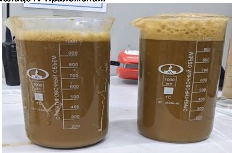
Рисунок 2 а – Фото солевого раствора из 6-го выпарного аппарата, направляемого на центрифугу для обезвоживания
