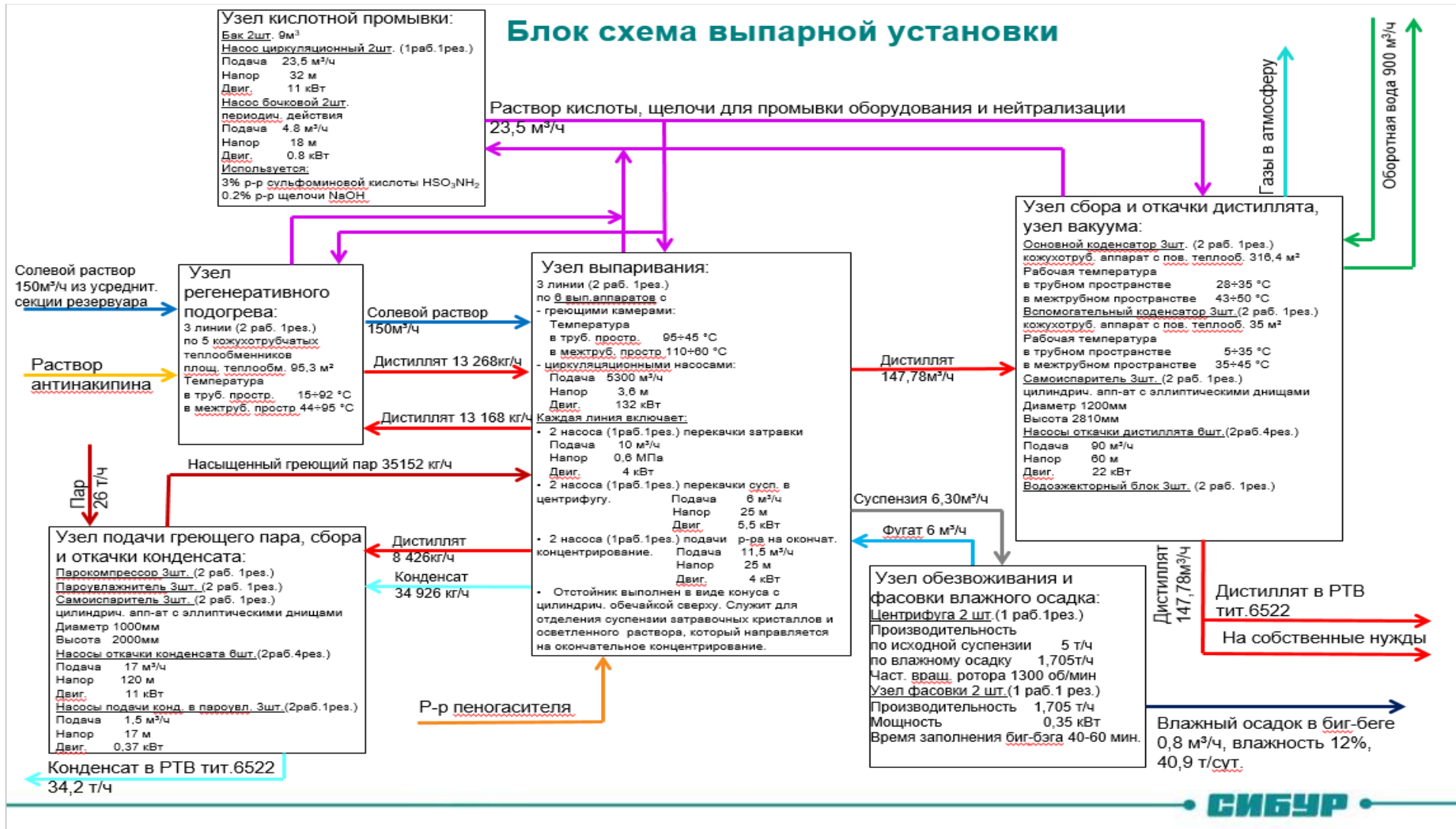
Рисунок II – Блок-схема выпарной установки
